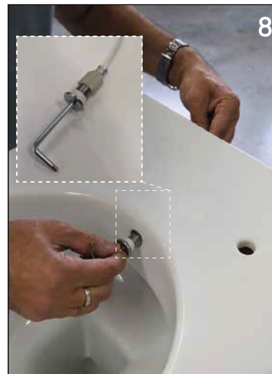
centrare attraverso la brugola e avvitare center through the Allen key and screw
