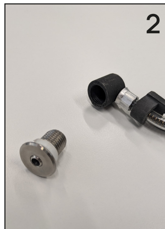
svitare ugello di erogazione unscrew dispensing nozzle
