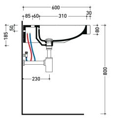
sezione longitudinale / section
