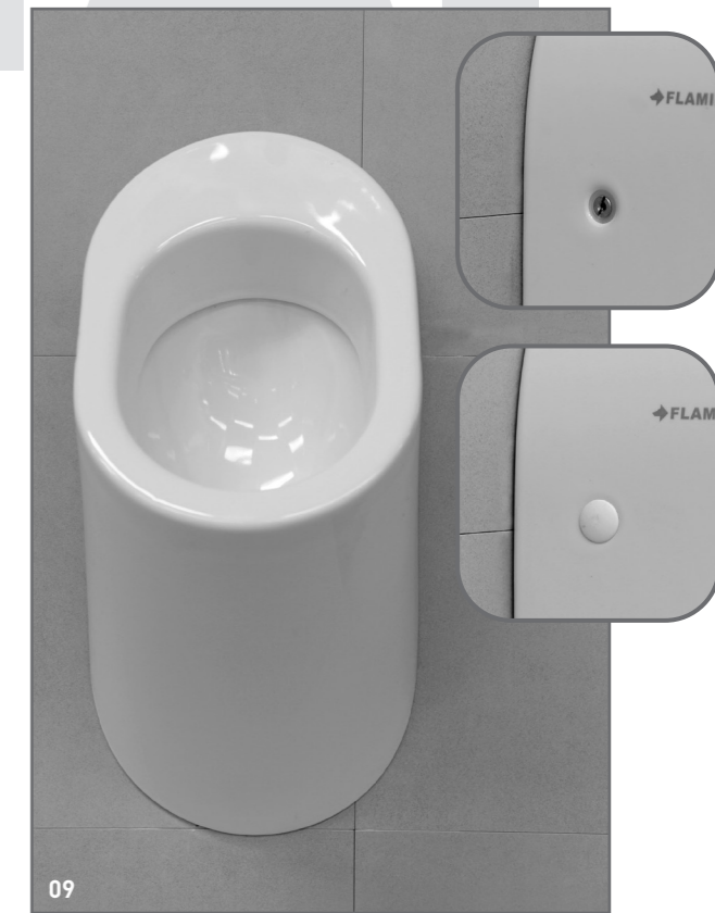
09 Installation des Urinal. Schieben Sie das Urinal auf die Wand über die Laschen, nachdem Sie den Zulaufgummi und den Ablauf mit Gleitmittel eingestrichen haben. Befestigen Sie danach das Urinal wie auf der Abbildung dargestellt. Installation de l'urinoir: monter l'installation sanitaire au mur après avoir lubrifié la partie en caoutchouc. Attachez solidement l'installation sanitaire au mur comme indiqué sur le schémas.
