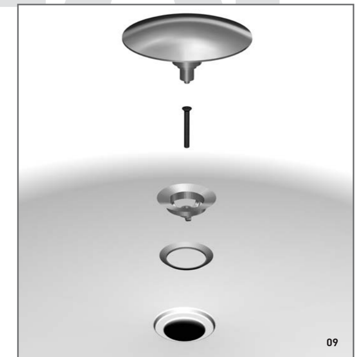
09 Nehmen Sie das Ablaufventil, dichten dieses ein und platzieren Sie es im Ablaufloch der Wanne. Drehen Sie nun die Schraube in das Unterteil des Syphon fest ein. Nehmen Sie den Excenterstopfen und bringen diesen in die dafür vorgesehene Öffnung ein. Drückend schließt/öffnet der Excenterstopfen den Ablauf. (Klickventil). Fixer la bonde d'évacuation au siphon par la vis inclus; serrer jusqu'à écrasement de la garniture; visser la bonde d'évacuation à la structure; pour ouvrir ou fermer la sortie, presser la bonde.
