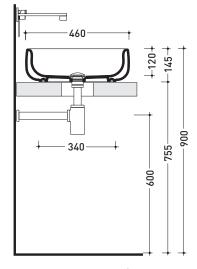
sezione longitudinale / section
