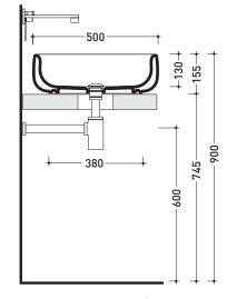
sezione longitudinale / section
