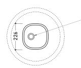
allaccio scarico tramite raccordo tecnico per lavabo in PP 40/50 mm con morsetto drainage connection: use a PP 40/50 mm connector for washbasin with holdfast
