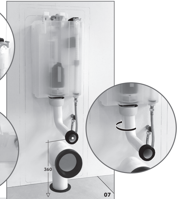
07 Branchement de l'eau et préparation pour l'installation du wc: suivre attentivement les mesures de la connexion comme indiquées. Verbinden Sie den Flex-Anschlußschlauch mit dem Eckventil und richten das Zulaufrohr gerade aus. Prüfen Sie die Höhe des Zulaufrohres vom Fußboden.
