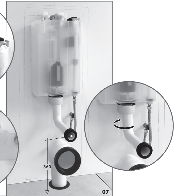
07_Allaccio del carico acqua e predisposizione alla connessione con il vaso: fare attenzione all'altezza del connettore da terra. Connect the flexible hose to the water inlet and adjust the flush pipe: check its height from the floor.
