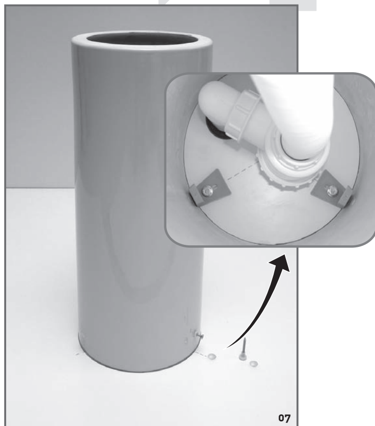
07 Fixation de la colonne: visser les équerres en PE au plancher et à la colonne; serrer la colonne seulement après l'avoir centrée. Befestigung der Säule: Schrauben Sie die Befestigungsteile fest auf den Boden und stellen die Säule darüber.
