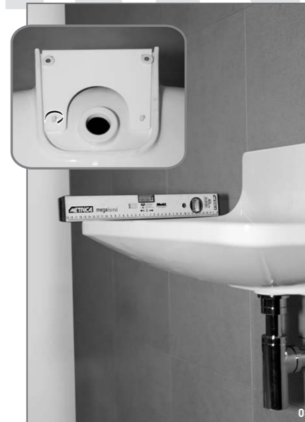
08 Befestigen und Ausrichten des Becken: Befestigen Sie das Becken auf der Konsole und richten dieses mittels den Kunststoffschrauben aus. Mise à niveau de la vasque: positionner la vasque sur l'équerre et ajuster le niveau en utilisant les vis plastique.
